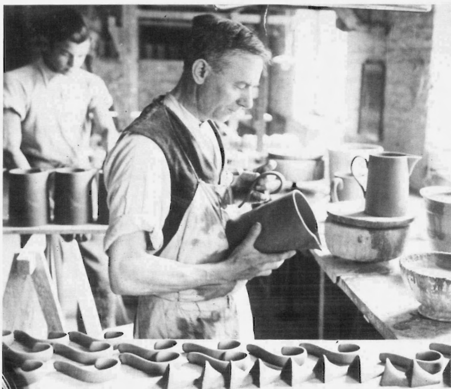
Garneren van een melkkan met tuit en oor. De vormafdeling, ca 1930. (Foto coll. Gemeentearchief Maastricht)
