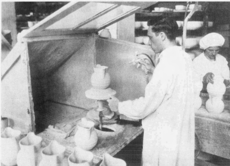
Het glazuren met een glazuurspuit was mannenwerk. De vernisafdeling, ca 1935. (Foto coll. Gemeentearchief Maastricht)
