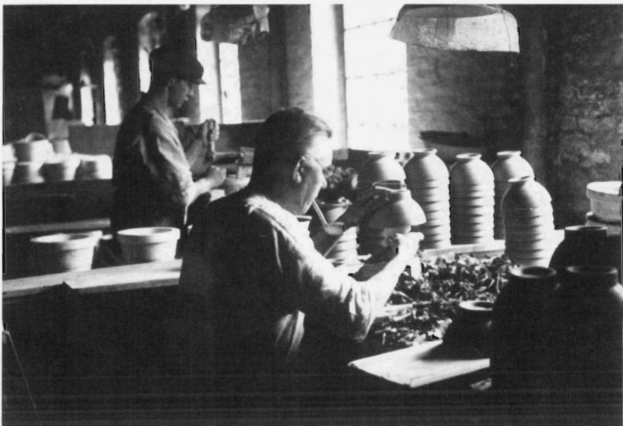
Het maken van kommetjes met behulp van een jolly. De vormafdeling, ca 1930. (Foto coll. SHCL Archief NV Koninklijke Sphinx Maastricht)
