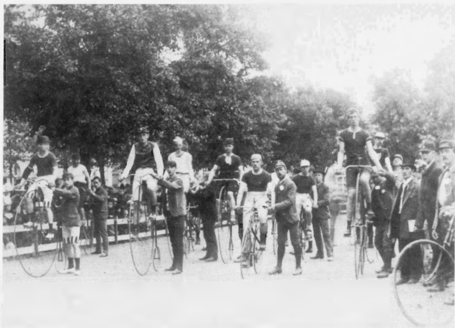
Tijdens de wielrenwedstrijd in 1898 op het Vrijthof in Maastricht, was het fietsontwerp volop in ontwikkeling en waren de Ordinary en de veiligheidsfiets nog met elkaar in concurrentie. Pas na de toepassing van de luchtband rond 1890, zou de veiligheidsfiets het gebruik van de Ordinary definitief verdrijven. (Foto coll. ANWB)
