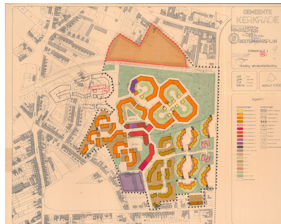
Detail van de kaart bij Bestemmingsplan Domaniale. Bij het herinrichten van het Willem-terrein moest men rekening houden met het voorkomen van oude schachten. Deze zijn op de kaart te zien als concentrische cirkels, bijvoorbeeld rechtsboven in het groene vak. Ook verschijnt in deze periode het opvallende bloemkoolpatroon dat de wijk vandaag de dag nog makkelijk herkenbaar maakt. [HCL, Provinciale Griffie, toegangsnummer 04.09 inv. nr. 1572]
